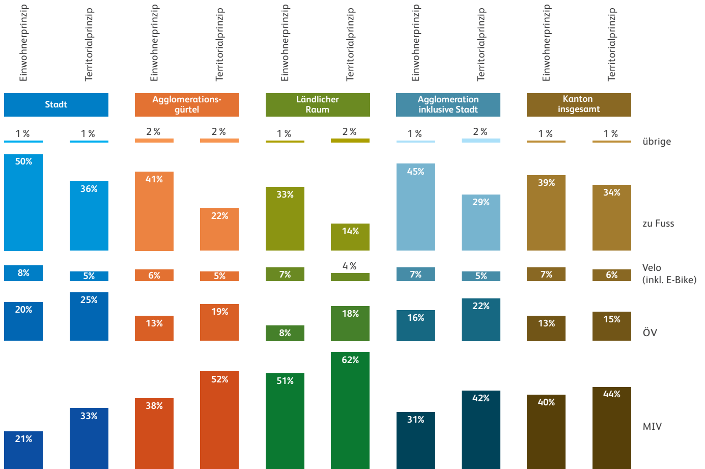
Abb. 46: Vergleich des einwohnerbasierten Modal Split mit dem Modal Split nach Territorialprinzip für das Jahr 2015 und für Etappen (LUSTAT 2 , Berechnung Hochschule Luzern).
